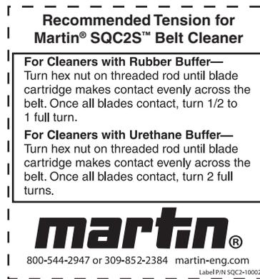
Figure 4. Martin® SQC2S™ Tensioning Label, P/N SQC2-10002
